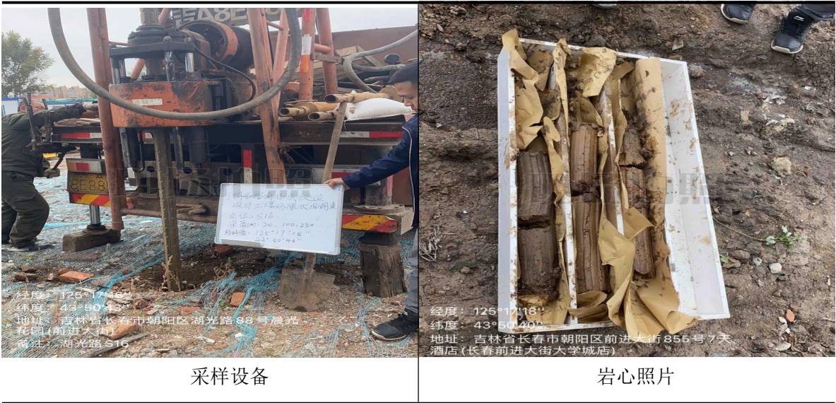
图 7-3 土壤采样设备及岩心照片
